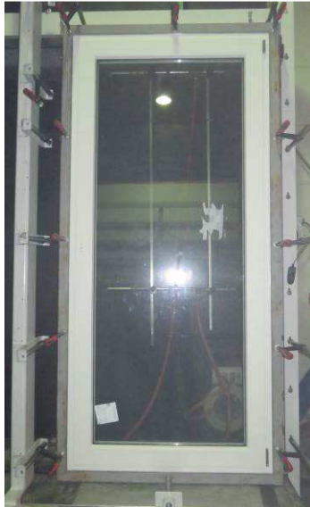
Bild 1 Probekörperansicht auf Prüfstand Fenster geschlossen
